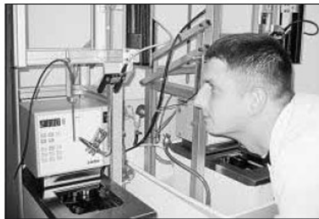
Dirk Dietrich am Quecksilber-Volumendilatometer: Er kann damit kleinste Volumenänderungen sichtbar machen. FOTO: A. KLEIN
